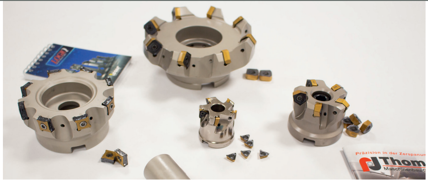
Schaffen was weg: Mit diesen Wendeschneidplatten-Fräsern von Iscar konnte Thomé die Grundplatte wirtschaftlich und prozesssicher fertigen © Iscar
